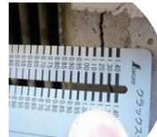
基礎、壁などのひび割れ(クラック)の状態や幅を計測するスケール。名刺大サイズの薄いスケールは、インスペクターが肌身離さず所持。
